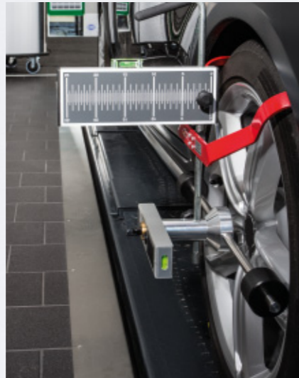
CSC-Tool'u araca merkezi ve paralel bir şekilde hizalama
